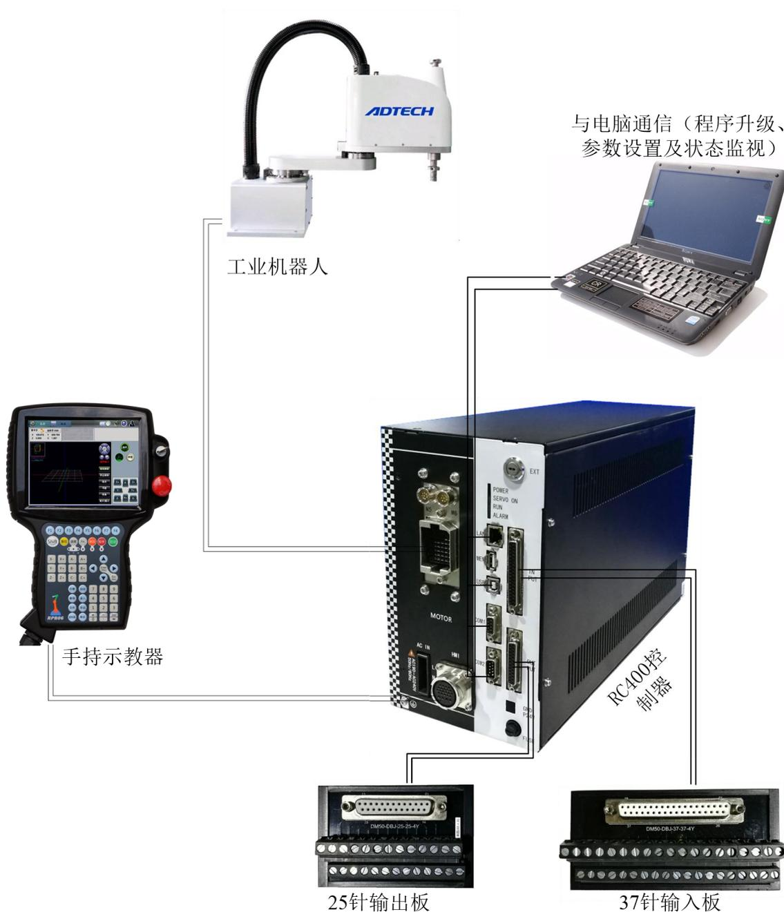
图 2-1-1 系统构成图
