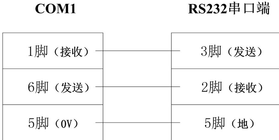
图 7-1-2 COM1 端口与 RS232 串口端连接示意图
